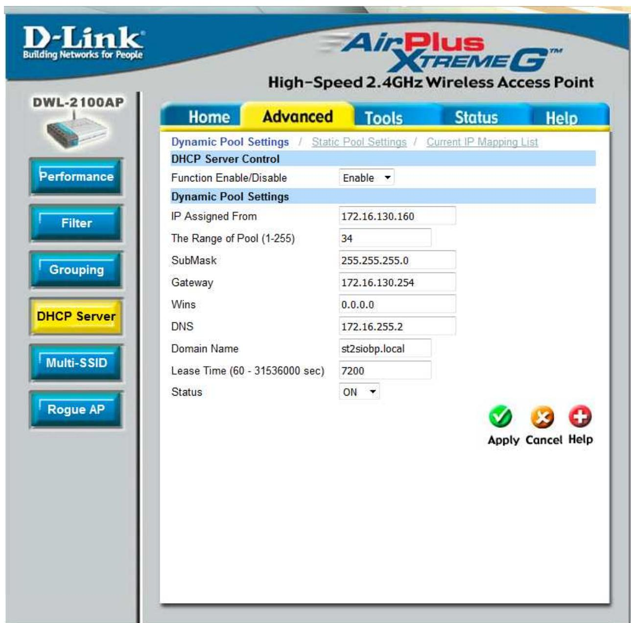
On change notre IP, on en met une en adéquation avec notre réseau, le masque ne change pas, et la passerelle est celle du réseau dans lequel on veut mettre le routeur ensuite on met apply
